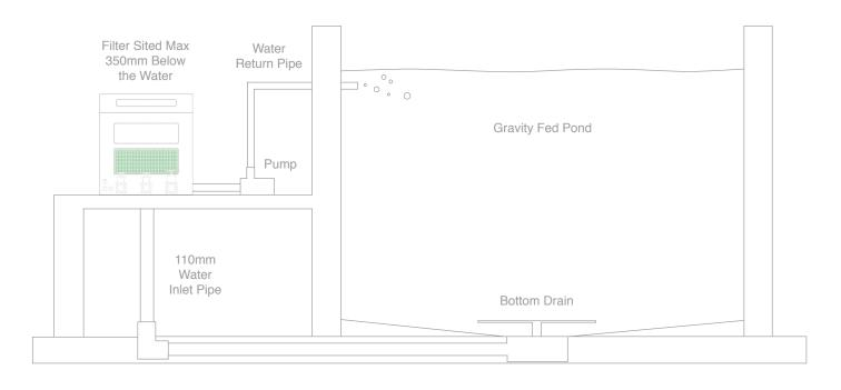
GRAVITY FED SYSTEM - INCORRECT INSTALLATION
